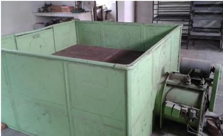
Gambar 18. Bak pengering dengan aliran udara hangat
